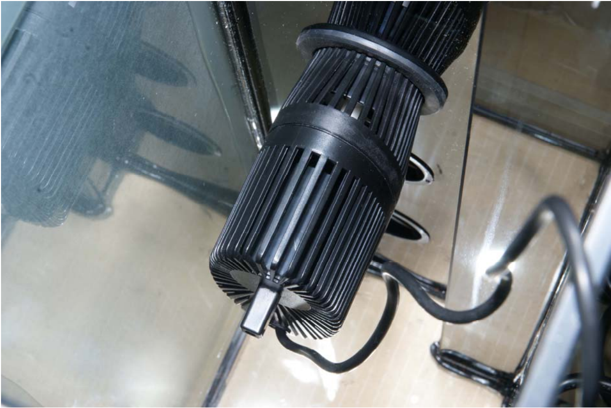
Photo 2: Pompe de brassage
